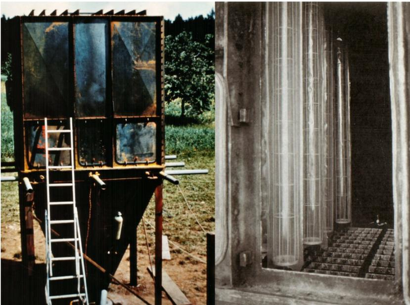
**Abb.3.111:** 13,6m<sup>3</sup>-Schlauchfiltergehäuse (a) und mit Stützkörpern mit Plastiküberzug
