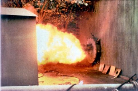
**Abb.3.88:** Staubexplosion in einem seitlich druckentlasteten  $1\text{m}^3$ -Behälter
