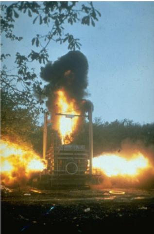
**Abb.3.90:** Staubexplosion in einem allseitig entlasteten  $30\text{m}^3$ -Behälter
