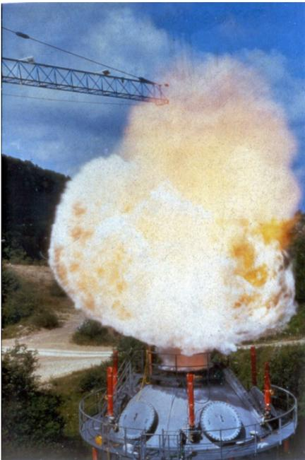
**Abb.3.105:** 250 m<sup>3</sup>-Behälter oben über  $F = 3.14 \text{ m}^2$  entlastet: Maisstärke-Explosion bei Optimalkonzentration:  $500 \text{ g/m}^3 \pm 125 \text{ kg}$  Staub.
