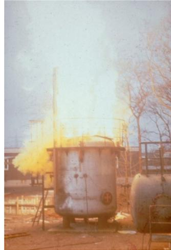
**Abb.3.89:** Staubexplosion in einem nach oben entlasteten  $10\text{m}^3$ -Behälter
