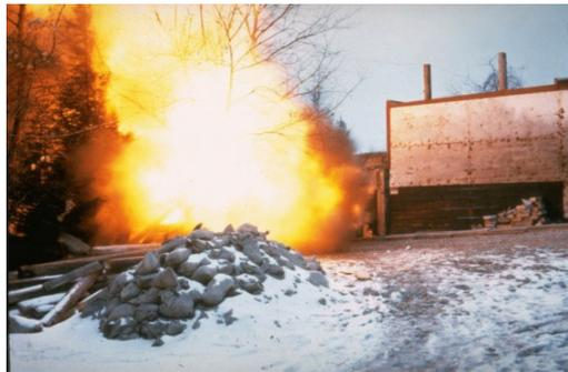
**Abb.3.91:** Staubexplosion in einem seitlich entlasteten  $60\text{m}^3$ -Bunker
