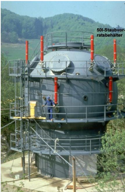
**Abb.3.103:** Geschlossener 250 m<sup>3</sup>-Behälter mit zehn 50l-Staubvorratsbehältern bestückt.
